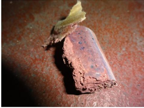
Holzzementboden mit Asbest
