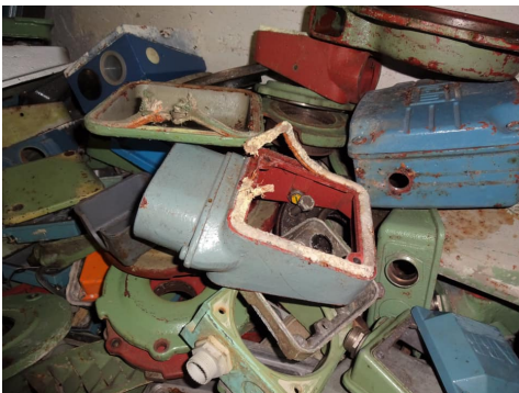
Tresse amianté dans vieille prise électrique 500 V. Photo: J. Meyer, Solgeo
