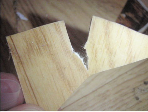
Photo d'un revêtement de sol en PVC composé de fibres sans amiante
