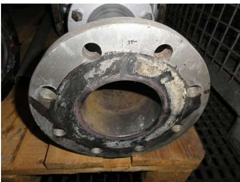
Reste d'un joint d'étanchéité. Si ces restes sont poncés, il y a un risque de libération importante de fibres d'amiante (Photo: Carbotech AG)
