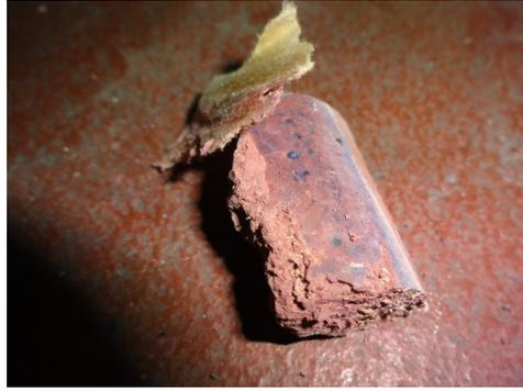
Pavimento in legno-cemento contenente amianto.
